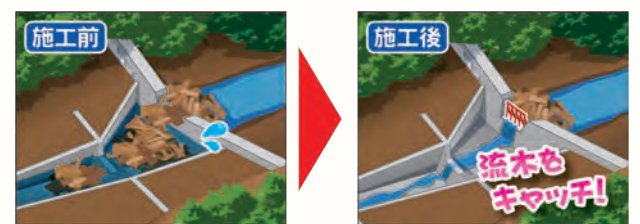
BA-7027 (堰堤スリット設置工事)
