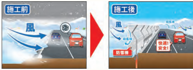
BA-6002 (防雪柵設置工事)
