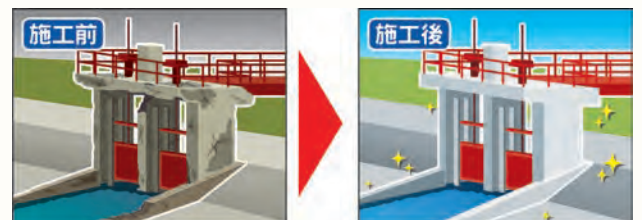
BA-7007 (樋門修繕工事)
