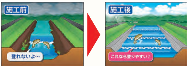
BA-7006 (魚道設置工事)
