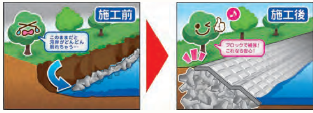
BA-7012 (護岸工事)
