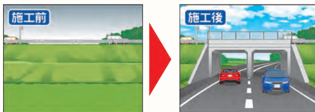
BA-9007 (BOXカルバート設置工事)
