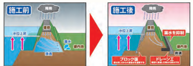
BA-7009 (堤防補強工事)
