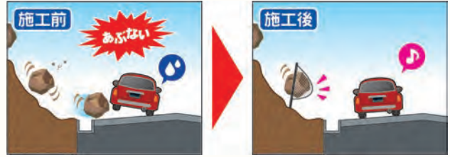
BA-6005 (防護柵設置工事)
