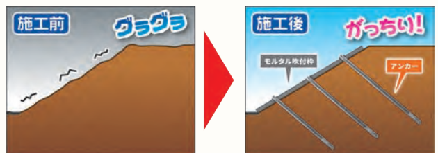
BA-8013 (グラウンドアンカー工事)
