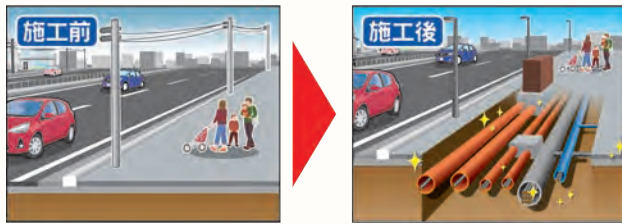
BA-2006 (電線共同溝工事)
