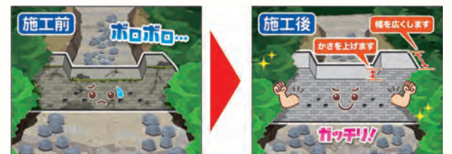
BA-7011 (砂防補強工事)
